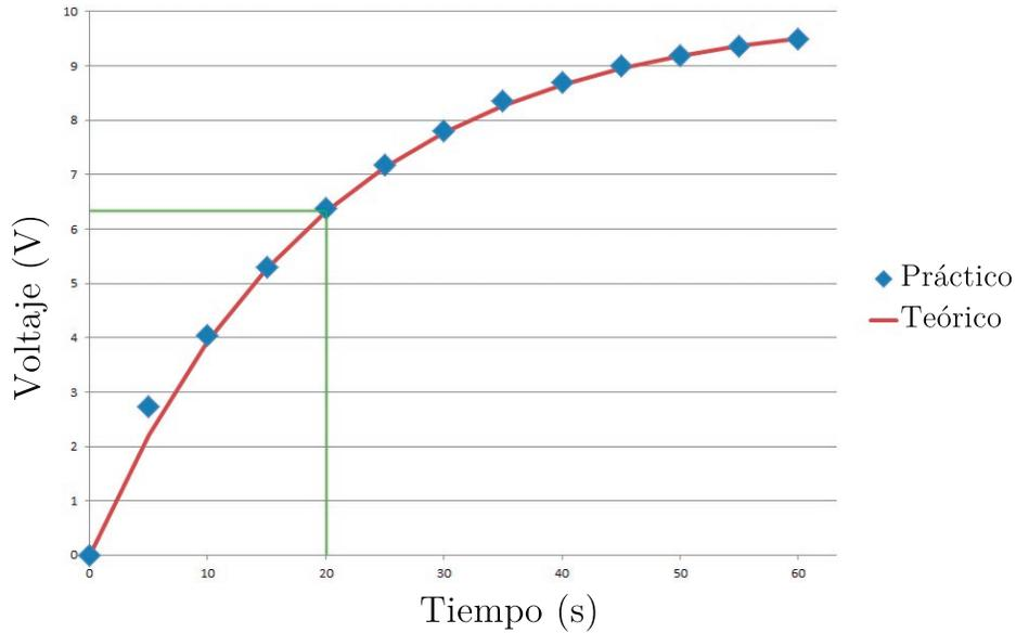
Figura 5: Voltaje en carga
