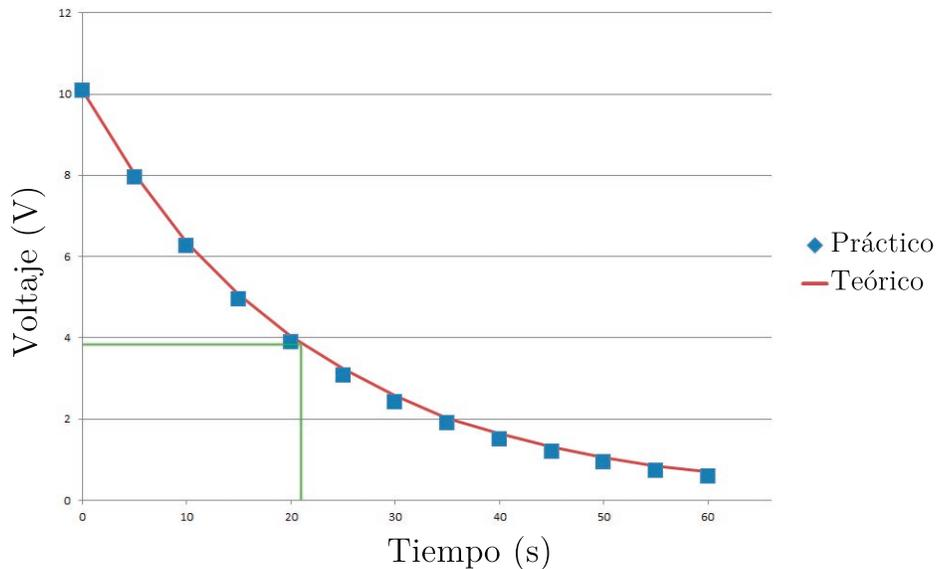
Figura 7: Voltaje en descarga
